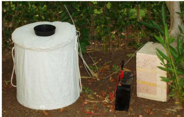
Fig. 26. Izqda.: Trampa CDC+CO2 ; dcha.: trampa BG.
