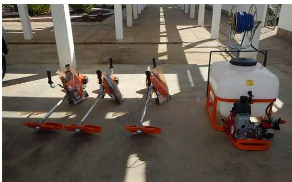
Fig. 34. Materiales para la realización de distintos tratamientos: pulverizadora eléctrica (izquierda), desbrozadoras y pulverizadora a motor en bancada (derecha).
